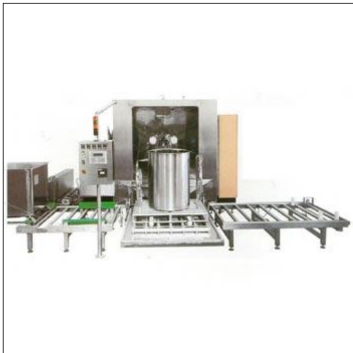
Figura 1: Impianto Lavaggio Bins – Vista frontale Aperto
